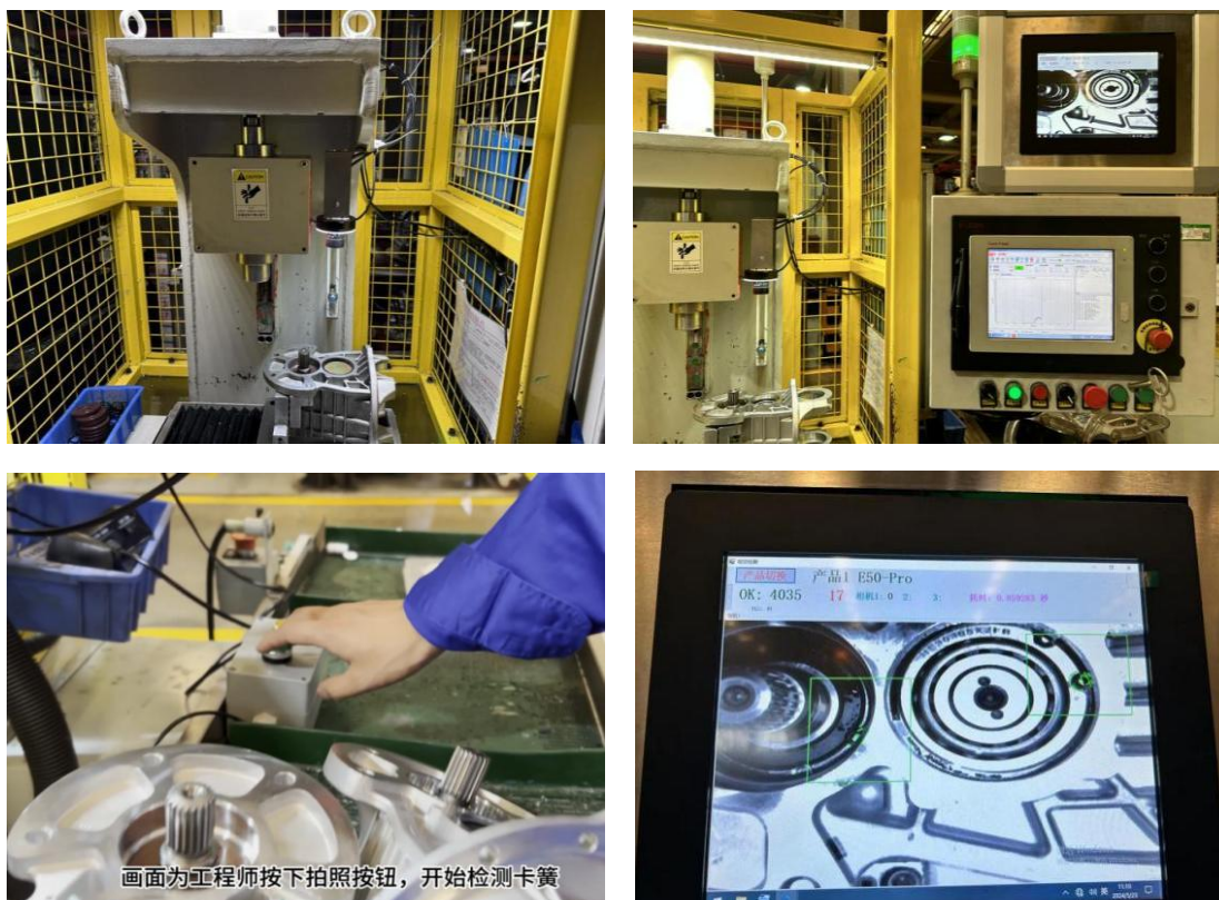
E50 系列主减总成一二轴卡簧视觉防错现场效果图：
