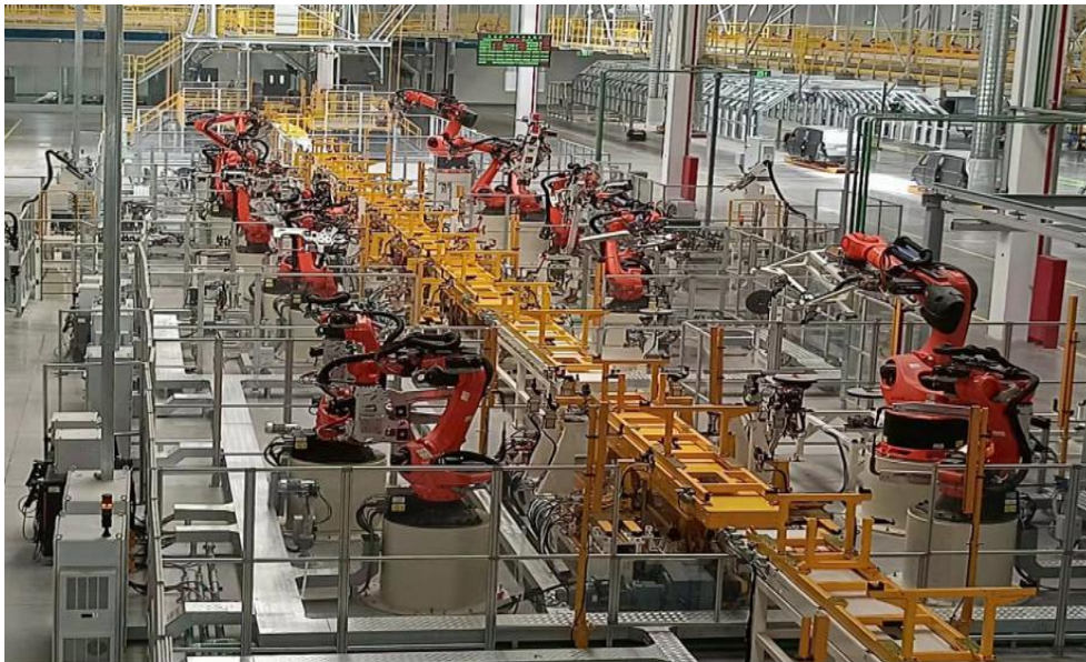
车身车间机器人自动化生产线
