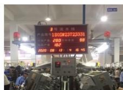
流水线FTQ、生产效率、运行状态实时监控
