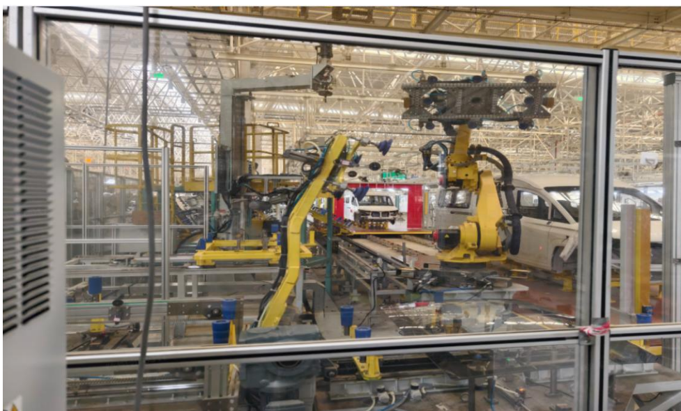
总装车间机器人涂胶工作站
